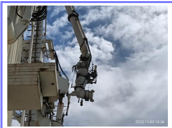
รูปที่ 3-34 Double Valves ป้องกันกรณีเรือเคลื่อนตัวออกจาก Loading Arm
